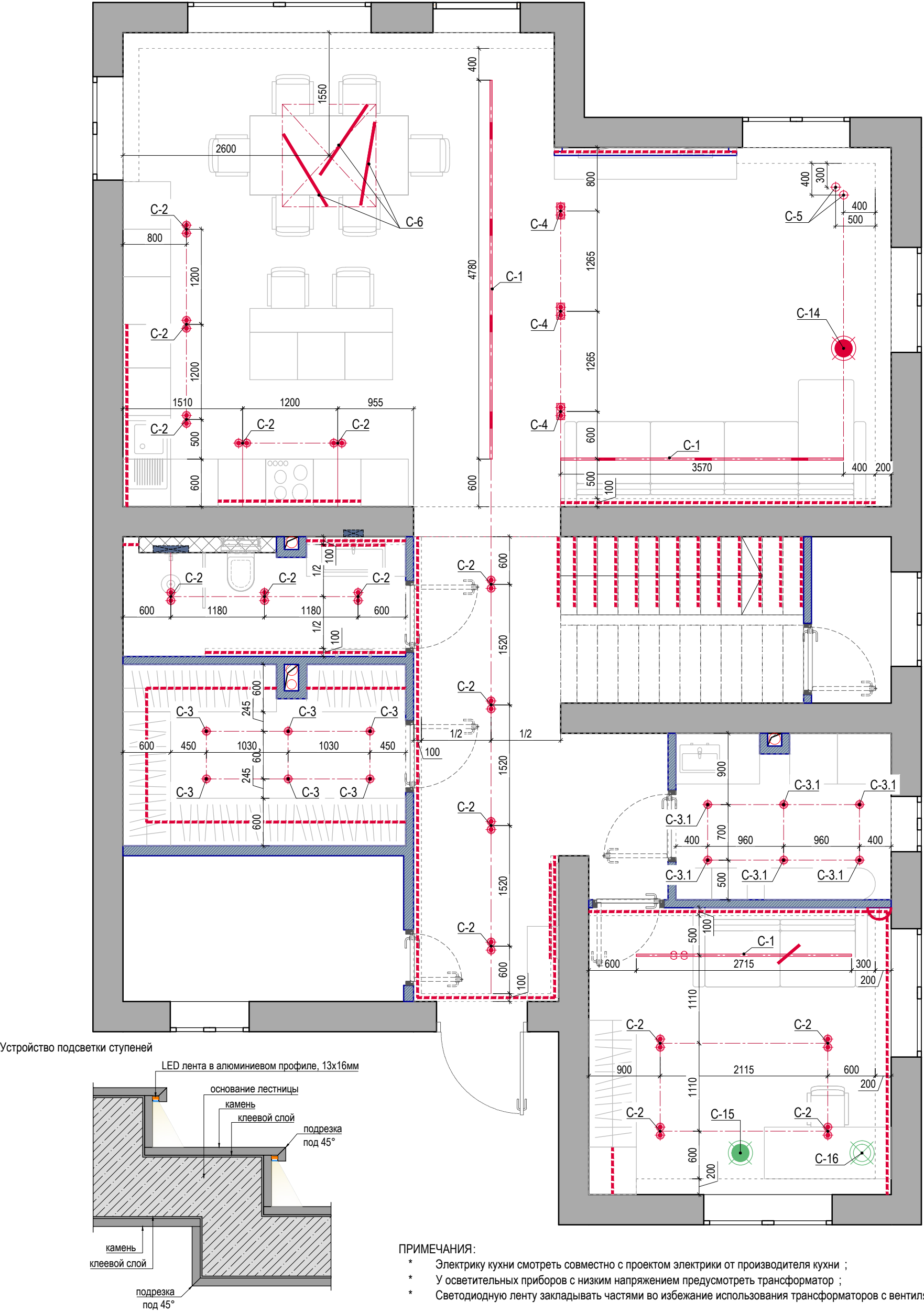
План привязки осветительного оборудования. 1 этаж
